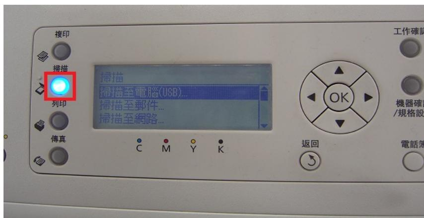
步驟 3、在雷射複合機的操作面板左邊的液晶面板顯示掃描選單，三角箭頭指到【掃描至郵件】功能，按【OK】鍵確認。
